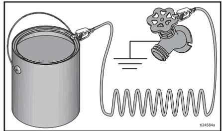
**Pour maintenir la continuité de la mise à la terre lors du rinçage du pulvérisateur ou de la décompression** : maintenez fermement la partie métallique du pistolet pulvérisateur contre le côté d'un seau métallique relié à la terre, puis actionnez le pistolet.
