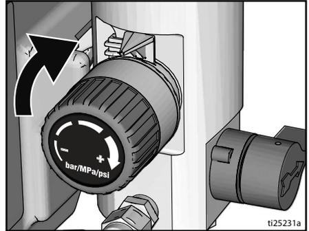
6. Mettez la vanne d'amorçage en position horizontale. Déverrouillez la gâchette.
