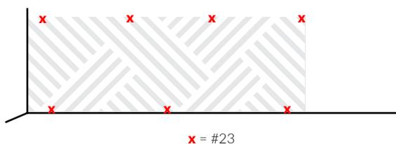
Clouer à la base des languettes en angle pour éviter que les clous ne soient visibles.
