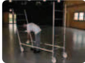
Pas de montants de départ. La base s'assemble directement avec les échelles de structure de 1 ou 2 m.
