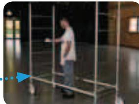
Auto-verrouillage de la base avec les échelles par inclinaison.
