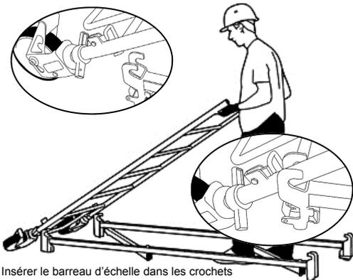
Insérer le barreau d'échelle dans les crochets
