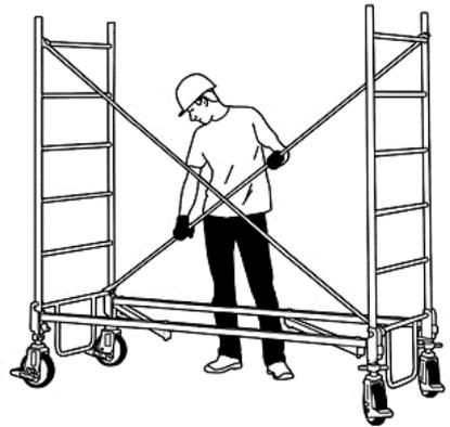
**10** Roues immobilisées, régler la base à l'aide d'un niveau à bulle en 3 phases A, B et C, en réglant une roue différentes pour chaque phase.
