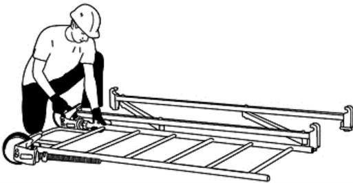
3 Serrer la tige de roue en abaissant la commande en fil d'acier et en serrant l'écrou.
