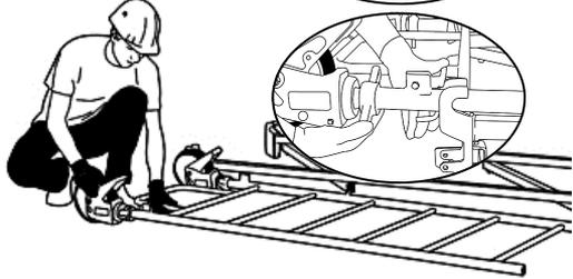
4 Positionner les montants d'échelle de base sur les crochets de la base, pivot de commande vers l'extérieur.
